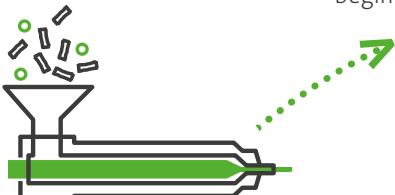
Die Pellets werden geschmolzen und in Formen gespritzt. Manchmal mischen wir der Kunststoffschmelze auch Farbe bei.
