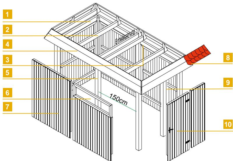
Konstruktion im Explosions-Detail
