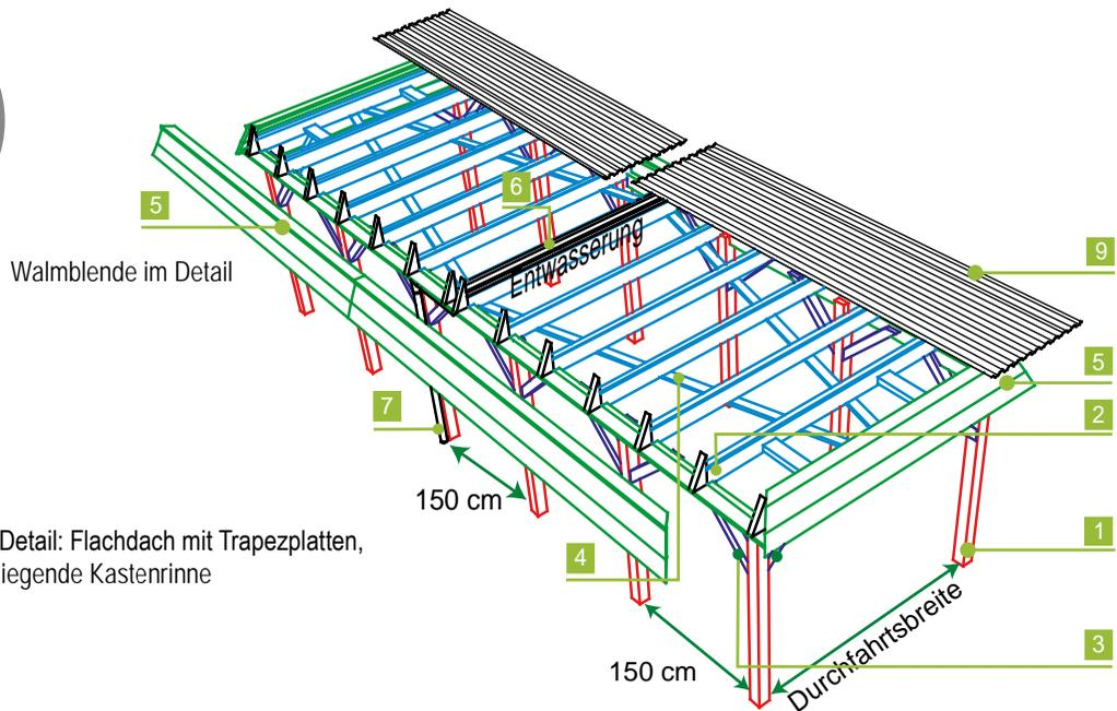
Explosions-Detail: Flachdach mit Trapezplatten, mittig innenliegende Kastenrinne
