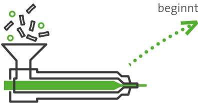
Die Pellets werden geschmolzen und in Formen gespritzt. Manchmal mischen wir der Kunststoffschmelze auch Farbe bei.
