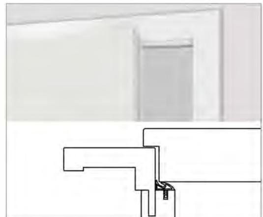
Bei der gefälzten Ausführung liegt das Türblatt auf der Bekleidung auf.
