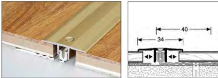
Beim Übergangsprofil können automatisch bis zu +/- 5 mm unterschiedlich hohe Hartbeläge verlegt werden. Durch einfach mechanische Anpassung des Schraubkanals ist ein Ausgleich von Höhenunterschieden +/- 8 mm möglich.
