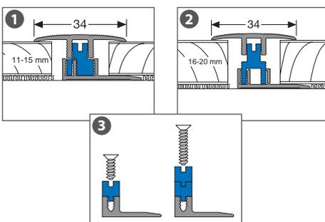
Das einzigartige Clipsystem für Vinylböden, für alle Belagsstärken von 4 bis 7,5 mm und Neigung verstellbar
