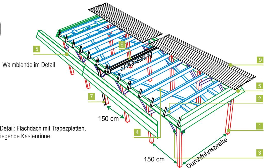
Explosions-Detail: Flachdach mit Trapezplatten, mittig innenliegende Kastenrinne
