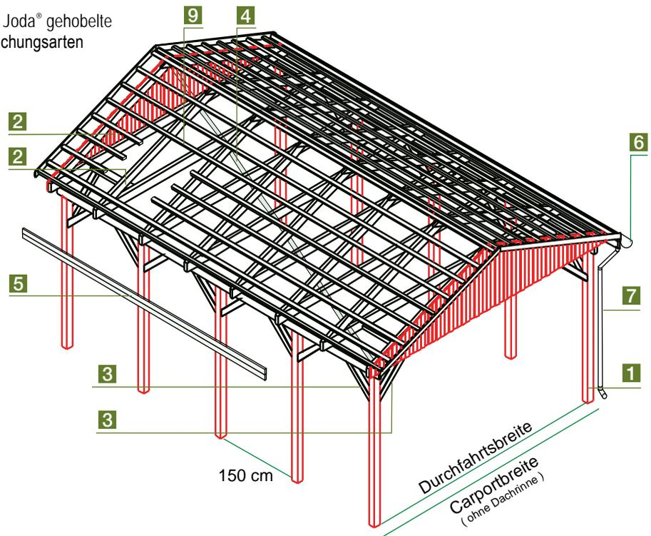
Konstruktion im Explosions-Detail, gilt für 22°-Dachneigung
