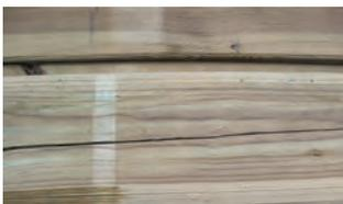
**Trockenrisse:** Das Quellen und Schwinden findet im Holz nicht gleichmäßig statt. Dadurch können sogenannte Trockenrisse entstehen. Sie beeinflussen in der Regel nicht die statischen Eigenschaften und die Festigkeit des Holzes und sind daher zu tolerieren.
