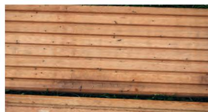
**Pinholes:** Hierbei handelt es sich um Fraßgänge kleiner Insekten, die keinerlei Einfluss auf die Dauerhaftigkeit oder Statik des Holzes haben. Die Insekten sind nicht mehr aktiv. Der Durchmesser der Pinholes beträgt ca. 1 bis 1,5 mm. Pinholes kommen z. B. bei Bangkirai und vereinzelt bei Massaranduba vor.
