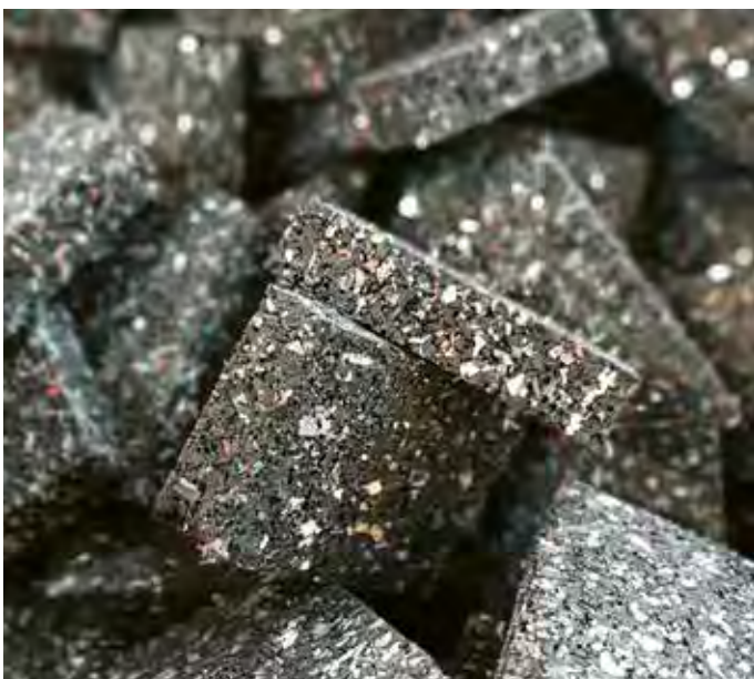
Isopads aus 95 % Altreifengranulat
