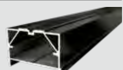
BIG-Isostep (Alu) 54 Terrassenlager Abstand Auflagepunkte max. 110 cm
