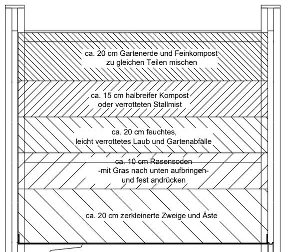
zersetzungsfreier, dünnmaschiger und nicht durchbeißbarer Maschendraht - zum Schutz vor Wühlmäusen und Maulwürfen (nicht im Lieferumfang enthalten).
