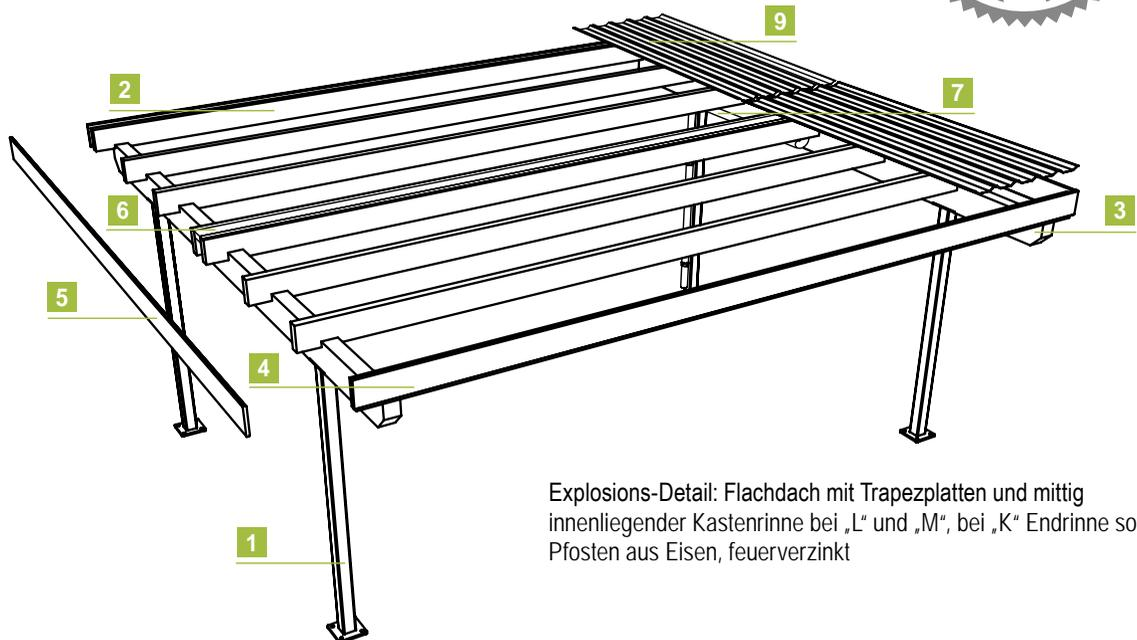
Explosions-Detail: Flachdach mit Trapezplatten und mittig innenliegender Kastenrinne bei „L“ und „M“, bei „K“ Endrinne sowie Pfosten aus Eisen, feuerverzinkt
