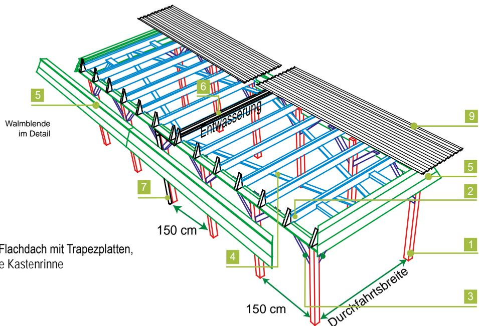
Explosions-Detail: Flachdach mit Trapezplatten,
