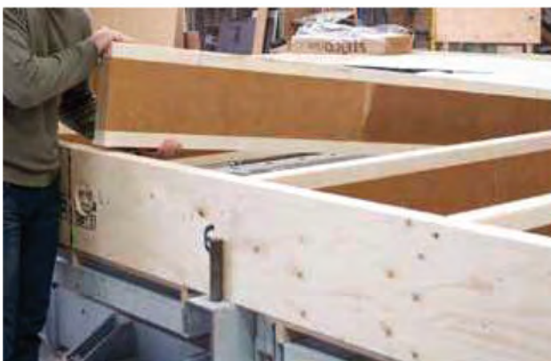
Vorfertigung von Wandelementen mit STEICO LVL R und STEICO Stegträgern
