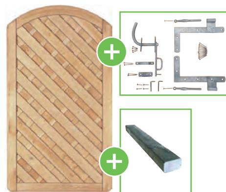
gefertigt aus Kiefer/Fichte, druckimprägniert grün, Rahmen ca. 45 x 45 mm, geklammert, Lamellen ca. 8 x 95 mm, geriffelt und Edelstahl verschraubt, Leisten ca. 12 x 30 mm, Maschenweite ca. 10 x 10 cm
