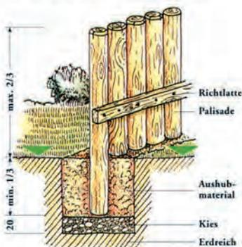
**Fachgerechter Einbau von Palisaden**
