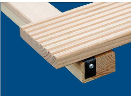
Am Anfang und am Ende der Terrasse wird die Lasche des Halters umgeschlagen und an der Stirnseite der Unterkonstruktion festgeschraubt. Alternativ kann man die überstehende Lasche auch absägen und die Diele sichtbar von oben verschrauben.
