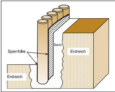
Palisaden sollten nicht mit Farbe oder Lasur gestrichen werden, da sich dann Feuchtigkeit unter der Oberfläche staut und zu Fäulnis führen kann. Das Holz muss „atmen“ können!
