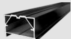
BIG-Isostep (Alu) 54 Terrassenlager Abstand Auflage- punkte max. 110 cm
