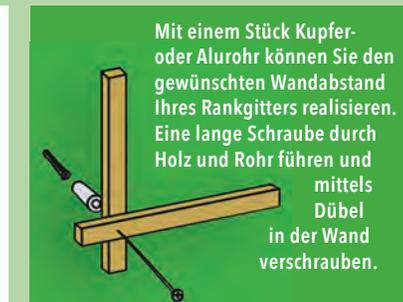
Mit einem Stück Kupfer- oder Alurohr können Sie den gewünschten Wandabstand Ihres Rankgitters realisieren. Eine lange Schraube durch Holz und Rohr führen und mittels Dübel in der Wand verschrauben.
