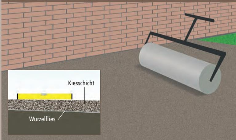
Bei der Planung Ihrer Terrasse sollten Sie den Sonnenverlauf und die vorrangige Windrichtung beachten. Stehen Standort und Grundfläche fest, gilt es, das benötigte Material zu berechnen und den Boden vorzubereiten. Nach der Abtragung des Mutterbodens ist es sinnvoll, ein Wurzelflies zu verlegen und die Fläche mit einer 5 cm starken Kiesschicht zu befüllen und zu verdichten. Hierbei sollte ein Gefälle von ca. 2 cm / 1 m in Wasserablafrichtung geschaffen werden.
