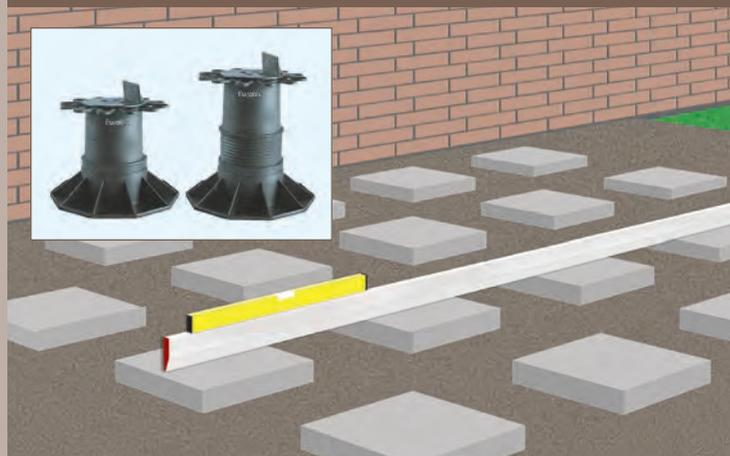
Als Fundament können Gehwegplatten oder größere Betonsteine dienen. Diese sind so auszulagen, dass ein Tragbalkenabstand von 40 bis 60 cm ermöglicht wird. Parallel zum Balken reicht ein Abstand von ca 75 cm. Es ist auf eine gleichmäßige Höhe und die Einhaltung des Gefälles zu achten. Im Fachhandel werden auch einstellbare Terrassenfüße aus Plaste angeboten. Abstände und Verlegehinweise sind dabei systembedingt.
