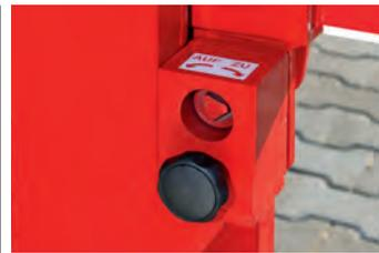
Der Verschlussbolzen der COMPACT Systemschranke rastet in offener und geschlossener Position automatisch ein. Abschließbar durch verschiedenen schließenden Rundzylinder, einschließlich 2 Schlüssel. (Der Schlüssel lässt sich nur in eingerastetem Zustand abziehen.)
