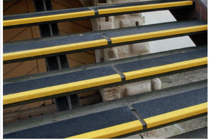
Antirutschwinkel für Treppen. Aus glasfaserverstärktem Spezialkunststoff (GFK). Hervorragende Abriebfestigkeit: 5 Mio. Begehungen. Hohe Trittsicherheit – Rutschfaktor R13 (DGUV-Regel 108-003, bisher BGR 181).
