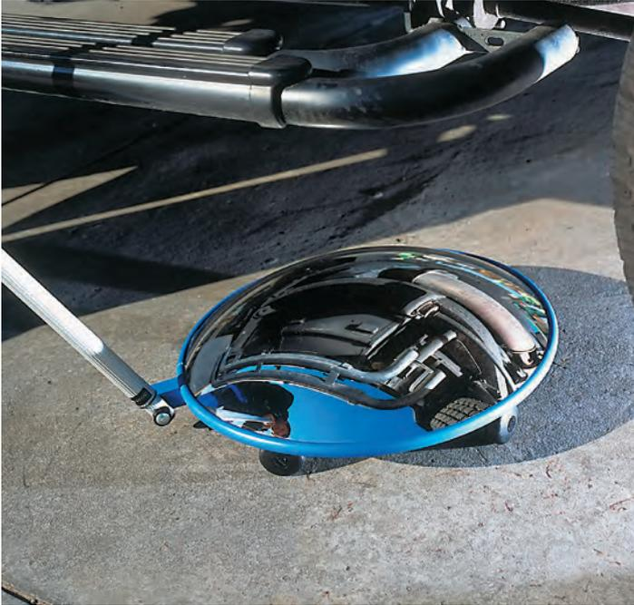
Sicherheitskontrollen an Fahrzeugunterseiten leicht und bequem durchführen.
