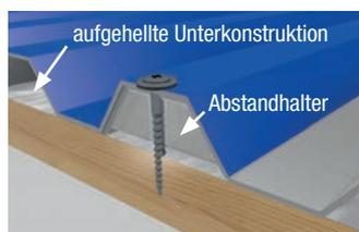
Querschnitt Befestigung der Überlappung
