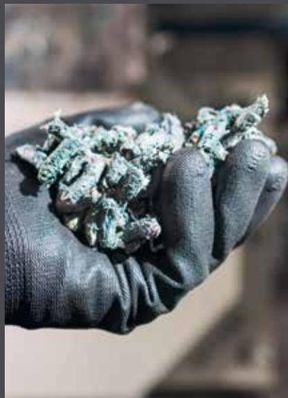
Durch Erwärmung entsteht unter hohem Druck unser Recycling-Werkstoff in Form von grauen Pellets, die nun in Spezialmaschinen zu den einzelnen Produkten verarbeitet werden.
