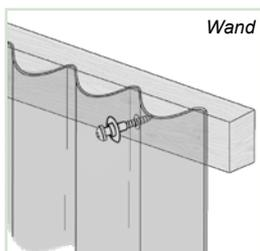
**Vermeiden Sie zu starre Befestigungen. Schrauben nicht zu stark anziehen, nur bis zum ersten Widerstand. Nach ca. 3 Monaten, wenn sich die Unterkonstruktion gesetzt hat, müssen die Schrauben nachgezogen werden.**
