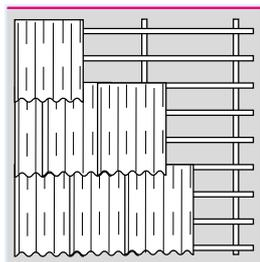
Die Verlegung erfolgt entgegen der Hauptwindrichtung von der Traufe zum First. Es treten Maßänderungen bei Temperatur- und Feuchtigkeitsschwankungen auf (bis zu 3 mm/m Länge). Diese sind mit zunehmender Plattenlänge zu addieren, deshalb empfehlen wir, die Verlegelänge der Platte auf 4 m zu begrenzen. Bei größeren Dachlängen sind zwei oder mehrere Platten überlappend zu verlegen.
