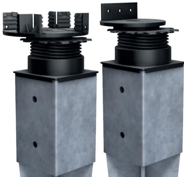
**Wir empfehlen:** Nach dem Einschlagen der Bodeneinschlaghülse sollte der Abstand zwischen Kopf und Erdreich 4 cm betragen. Bei einem zu weichen Erdreich sollte das Loch für die Bodeneinschlaghülse mit einem Erdbohrer vorgebohrt und vor dem Einsetzen mit Beton ausgegossen werden. So ist eine höhere Stabilität gewährleistet.
