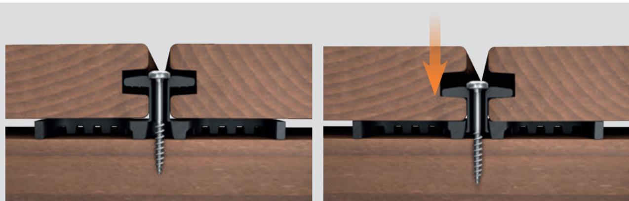
Flexibler Spannungsbereich von 5 mm durch Sollbruchstelle.
