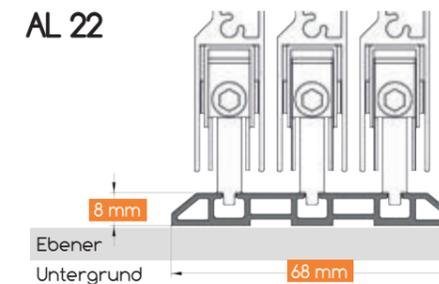
Durch die spezielle Rollenaufnahme der Schiebeelemente hat die AL22 am Boden eine niedrige Führungsschiene für eine nahezu ebene Übergangsschwelle.
