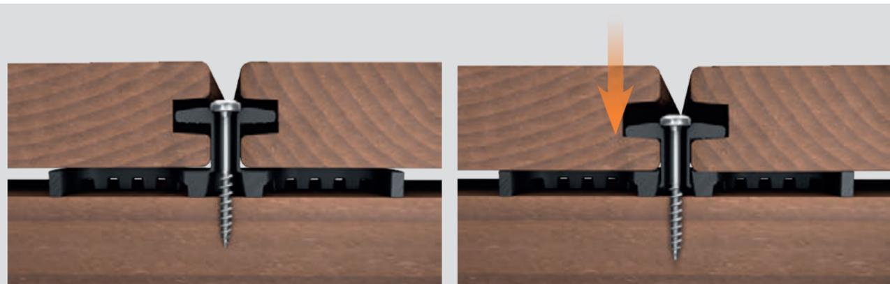
Flexibler Spannungsbereich von 5 mm durch Sollbruchstelle.
