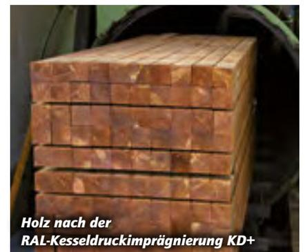
Holz nach der RAL-Kesseldruckimprägnierung KD+
