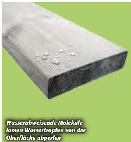
**Wasserabweisende Moleküle lassen Wassertropfen von der Oberfläche abperlen**
