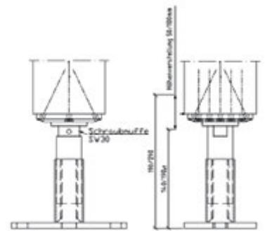
Der Stützenfuß Pedix kann einfach am Hirnholzschnitt angebracht werden: Die Dichtung auf den Stützenfuß legen und beide Teile zentrisch auf der Hirnholzfläche platzieren. Hinweis: Zur leichteren Montage können Fußplatte und Abdeckhülse abgeschraubt werden.
