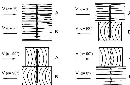
Charakteristischer Wert der Tragfähigkeit der Verbindung  $R_{ax,k}$  nach ETA-11/0024
