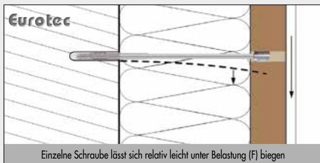
Um dem System EiSYS-H eine höhere Steifigkeit zu geben, werden die Verstellerschrauben paarweise und V-förmig angebracht.
