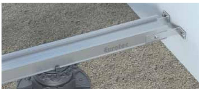
Der **Wandanschlusswinkel EVO** eignet sich hervorragend als Lagesicherung für eine Terrassenunterkonstruktion aus Aluminium. Der Winkel dient zur direkten Befestigung des Alu-Systemprofils EVO an der Wand. Pro Alu-Profil werden zwei Wandanschlusswinkel EVO benötigt. Durch die vorhandenen Langlöcher am Wandanschlusswinkel kann sich die Unterkonstruktion problemlos ausdehnen, wodurch ein Verrutschen der Unterkonstruktion vermieden wird.
