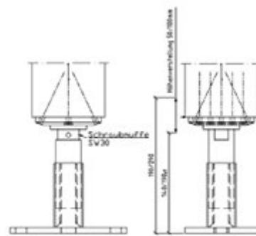
Der Stützenfuß Pedix kann einfach am Hirnholzschnitt angebracht werden: Die Dichtung auf den Stützenfuß legen und beide Teile zentrisch auf der Hirnholzfläche platzieren. Hinweis: Zur leichteren Montage können Fußplatte und Abdekhülse abgeschraubt werden.
