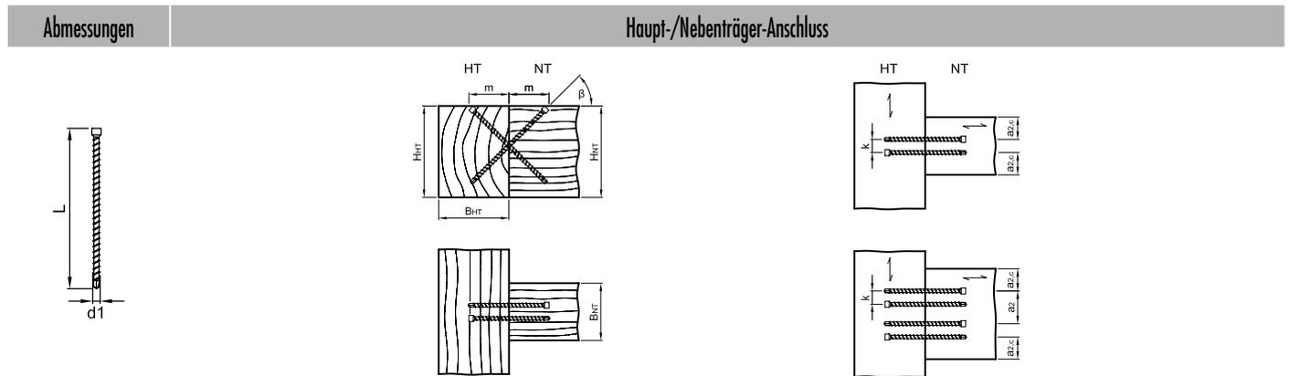
$a_1 = \text{min. } 50 \text{ mm}, a_2 = \text{min. } 30 \text{ mm}, k = \text{min. } 15 \text{ mm}$
