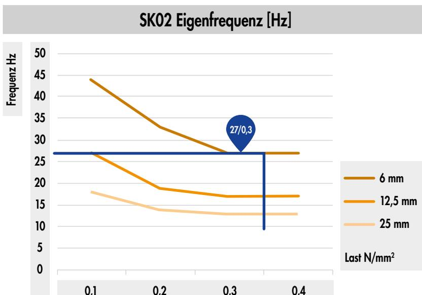
Im **nächsten Schritt** schauen wir uns die Störfrequenz genauer an. Dazu betrachten wir die folgenden Graphen und können somit feststellen, dass sich die Schallreduzierung im Niederfrequenzbereich verschlechtert hat. Niedrige Frequenzen (Bässe) lassen sich nur durch Masse isolieren. Die für die Bauakustik zu isolierenden Frequenzen beginnen im Bereich von 80Hz, weshalb dies zu vernachlässigen ist. Wenn keine Störfrequenzen vorgegeben sind, kann von 80Hz ausgegangen werden.
