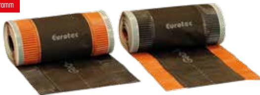
Der Rollfirst ist aus hochwertigem diffusionsfähigen PP Vlies (150 g) und plissiertem Aluminiumblech hergestellt. Dank des Vlieses ermöglicht das Band die Belüftung zwischen Trauf und First. Es besteht kein Risiko, dass Wasser oder Kleintiere unter die Dachkonstruktion gelangen.
