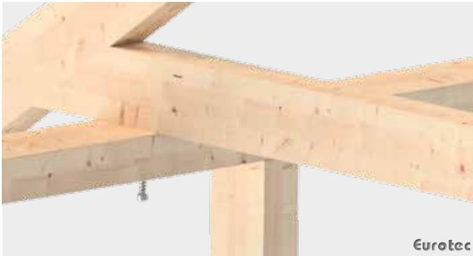
Befestigung von Querträgern bei leichten Holz-Rahmenkonstruktionen
