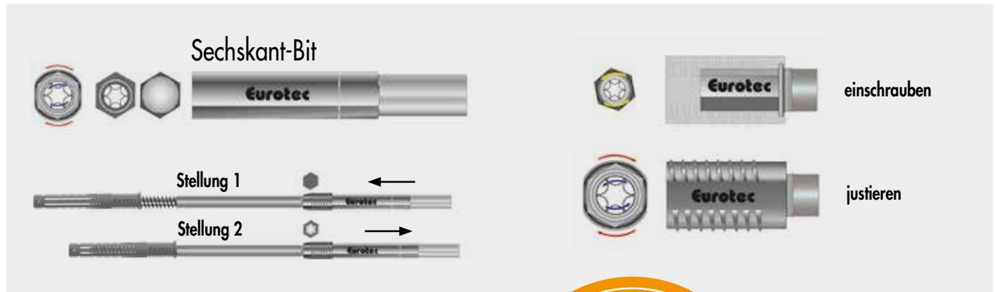
Die EiSYS-H Schraube ist mit einer freidrehenden Justierhülse/Verstellkopf ausgestattet, die eine Distanzregulierung zwischen Mauerwerk und Unterkonstruktion ermöglicht. Als Zubehör wird ein Sechskant-Bit mitgeliefert. Dieses wird sowohl zum Einschrauben der Schraube in den Untergrund, als auch zum Justieren der Unterkonstruktion durch den Verstellkopf genutzt.
