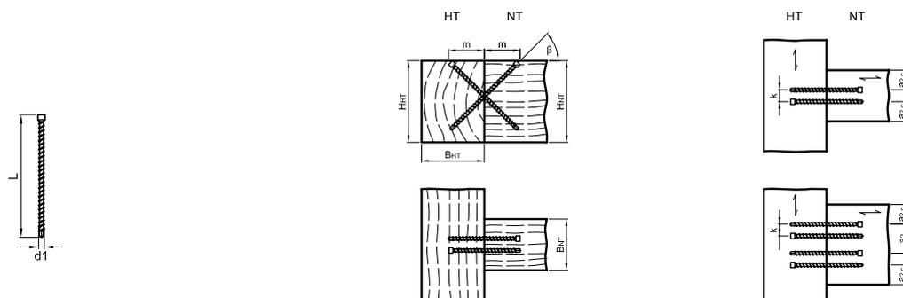
$a_2 = \text{min. } 33 \text{ mm}, a_{2,c} = \text{min. } 20 \text{ mm}, k = \text{min. } 10 \text{ mm}$
