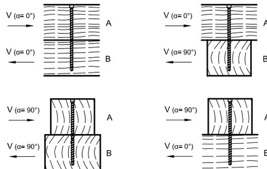
Charakteristischer Wert der Tragfähigkeit der Verbindung  $R_{ax,k}$  nach ETA-11/0024
