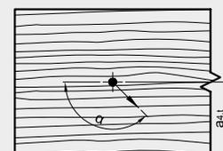
Ausgewertet ergeben sich die Mindestabstände für in Querrichtung beanspruchten KonstruX in vorgebohrten Löchern, wie folgt nach der Lage der Faserrichtung zu
