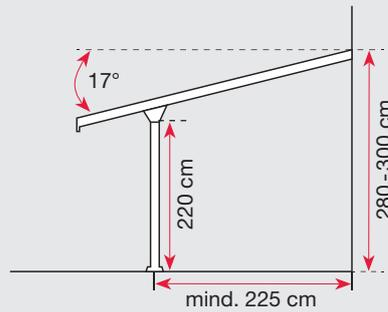
Anpassungsfähige Montage durch variable Firsthöhe und verstellbare Trägerpfosten
