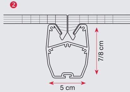
10 mm starke Polycarbonat Hohlkammerplatten werden in den Sparren eingeklickt
