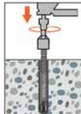
4. Ankerstange schlagend / drehend mit Bohrhammer setzen
