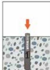
3. VAC Mörtelpatrone in das Bohrloch setzen
