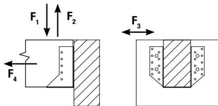
Entgegen der allgemeinen Annahme ist die Tragfähigkeit der Bodenbleche von Balkenschuhen relativ gering. Die tragenden Elemente bei Balkenschuhen sind die Verbindungsmittel wie CNA Nägel oder CSA Schrauben. Daher ist eine Ausnagelung stets nach den technischen Vorgaben konform und sorgfältig auszuführen. Um genügend Vorholz für die Nägel im Nebenträger zu bewahren, dürfen die maximalen Fugengrößen zwischen dem Hauptträger und dem Hirnholz der Nebenträger nicht überschritten werden.
