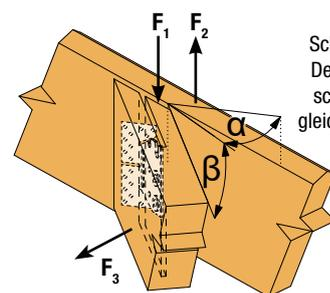
TU/S in einer Schifferanwendung. Der Nebenträger ist schräg gestellt, bei gleichzeitiger Neigung.
