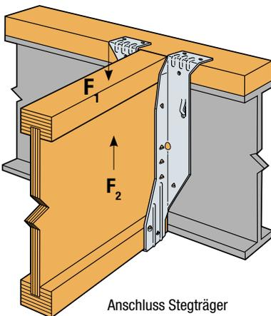
Anschluss Stegträger an einen Stahlträger mit Holzaufleger.
