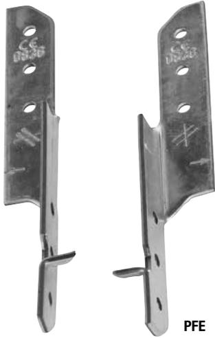
PFE Pfettenanker werden für die Zugverankerung von sich kreuzenden Hölzern verwendet und sollten vorzugsweise diagonal gegenüberliegend verbaut werden. Neben den Zugkräften können horizontale Kräfte aufgenommen werden. Belastungsabhängig kommen 2 oder 4 Pfettenanker pro Anschluss zur Anwendung. Bei 2 Pfettenankern pro Anschluss werden 2 linke oder 2 rechte Verbinder benötigt. Die PFE werden satzweise (rechts + links) verkauft. Die Einschlagzacke dient als Montagehilfe.
