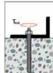
5. Montagedrehmoment mittels kalibriertem Drehmomentschlüssel aufbringen (Aushärtezeiten sind zu beachten)
