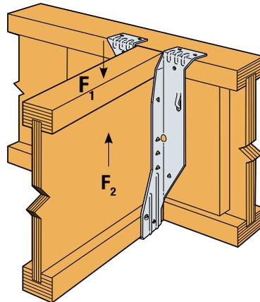
Anschluss eines Stegträgers an einen Stegträger als Hauptträger mit Stegverstärkung im Hauptträger
