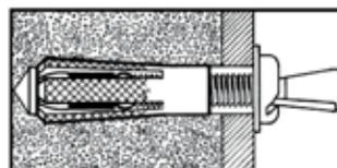
3. Spreizen des Messingdübels mittels Anziehen ( $T_{inst}$ ) der Schraube
