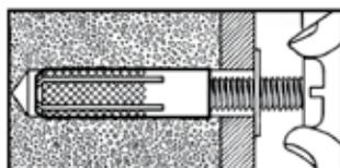
2. Messingdübel mit eingedrehter Schraube ins Bohrloch setzen
