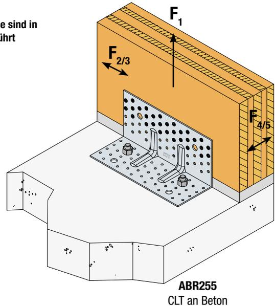
ABR255 Winkelverbinder eignen sich gut zur Aufnahme von hohen abhebenden und horizontalen Kräften. Angepasste Ausnagelungsvarianten lassen verschiedene Anschlussmöglichkeiten an Brettsperrholz zu.
