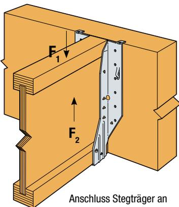
Anschluss Stegträger an Vollholz oder Holzwerkstoff.
