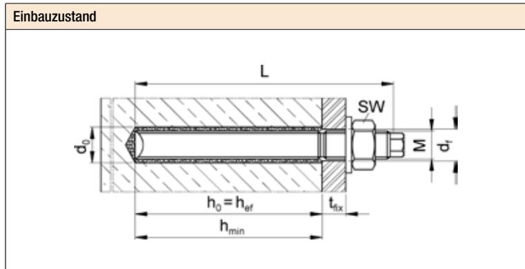
\*) Bei Verankerung im nassen Beton und in wassergefüllten Bohrlochern ist die Aushärtezeit zu verdoppeln.
