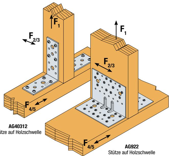
AG40312, AG40412, AG40314, AG40414 Winkelverbinder eignen sich zum Anschluss von Stützen und Balken auf Holz oder Beton in tragenden Konstruktionen.
