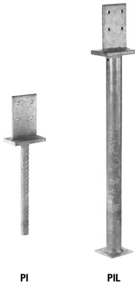
PI / PIL Stützenfüße sind für Holzbreiten ab 60 mm geeignet und werden direkt im Beton eingesetzt. Dabei darf der maximale Abstand der Druckplatte zum Beton beim Typ PI 50 mm und beim Typ PIL 250 mm betragen. Es können vertikale und horizontale Lasten aufgenommen werden.
