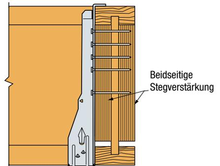
Wird ein Stegträger als Hauptträger verwendet, ist die Anordnung und Befestigung von Stegverstärkungen nach den Vorgaben der Stegträgerhersteller vorzunehmen.
