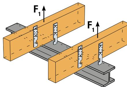
HE-Anker können auch für Konstruktionen verwendet werden, in denen die Hölzer unter den Stahlträgern angehängt werden sollen.
