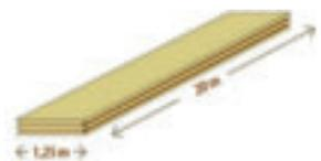
Die Ausführung von Decken mit BBS 125 bringt nicht nur bautechnische Vorteile wie selbsttragende und trockene Bauweise, Scheibenwirkung, formstabile Bauteile, ausreichenden Brand- und Schallschutz, sondern auch fertige Sichtoberflächen sowie ein hohes Maß an Wohnbehaglichkeit durch die positive Wirkung der Holzmasse auf das Raumklima.
