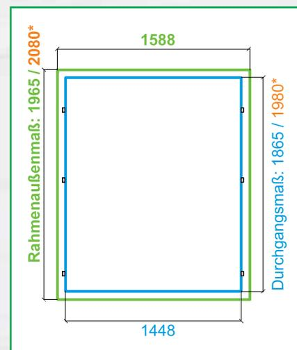
Das Loch- bzw. Einbaumaß für Türen und Fenster ist das Rahmenaußenmaß addiert um 10 mm auf beiden Seiten und 30 mm in der Höhe.
